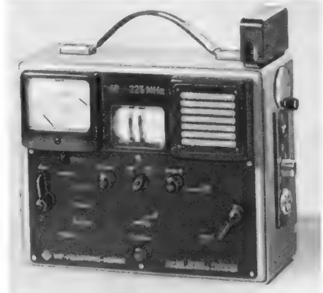
Bild 1. Ansicht des Feldstärkezeigers HUZ der Firma Rohde & Schwarz. Links von der Trommelskala das Anzeige-Instrument, rechts der Kontroll-Lautsprecher
