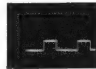
Bild 7. Eine Seite des Kontaktpaares schließt nicht
