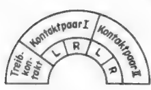
Bild 3b. Schaltstellungen des Umschalters S 2a/2 b
