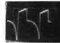
Bild 7. Eine Seite des Kontaktpaares schließt nicht
