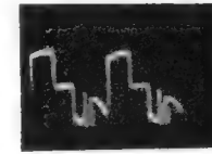
Bild 8. Bei diesem Zehacker ist eine Seite des Kontaktpaares verbrannt. Er war in einer Schaltung mit Wiedergleichrichtung betrieben worden, bei der ein mit einem Löschkondensator in Reihe geschalteter Widerstand defekt geworden ist, so daß sich starke Funkenbildung ergab.
