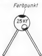
Bild 1. Beispiel für die Kennzeichnung eines Scheibenkondensators
